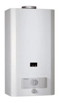
Газовый проточный водонагреватель MAG OE 11-0/0XZ C+ 311187 оснащен горелкой с автоматической модуляцией. Данный аппарат устойчиво работает при давлении газа 13 мбар. Корпус водонагревателя оснащен смотровым отверстием для контроля пламени. Возможна регулировка мощности в диапазоне 10-19,2 кВт. Для запуска водонагревателя достаточно небольшого расхода воды.
