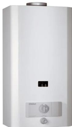
Газовый проточный водонагреватель MAG Premium 24 включается/выключается автоматически при открытии/закрытии крана горячей воды. Для удобства изменения мощности и температуры нагрева предусмотрены: терморегулятор и регулятор мощности, расположенные на корпусе водонагревателя. Для контроля наличия пламени предусмотрено смотровое окошко. Данный водонагреватель можно устанавливать в жилой зоне.
