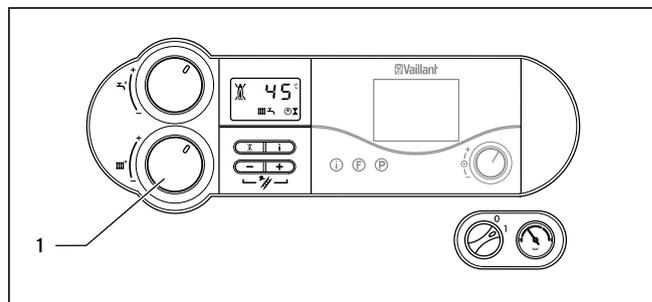
**4.11 Настройка температуры теплоносителя в подающей линии в случае использования регулятора**
