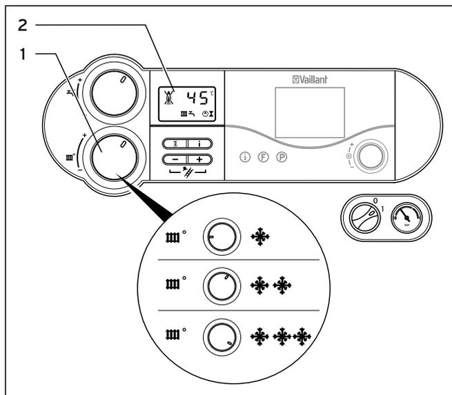
**4.10 Настройка температуры теплоносителя в подающей линии без регулятора**
